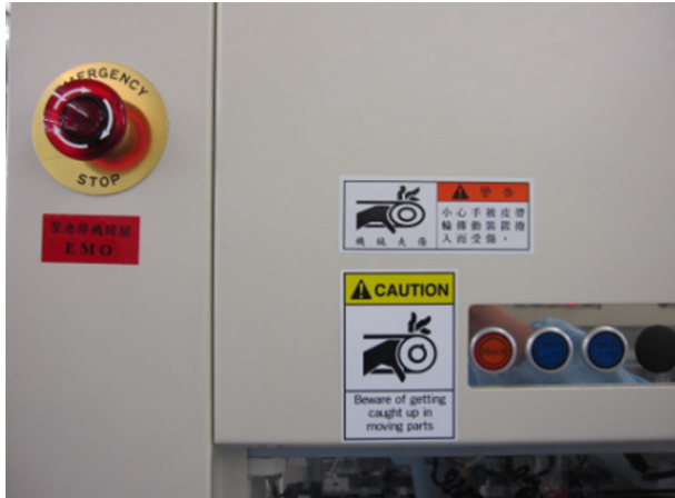
↑ 設備機台中英文危害標示
